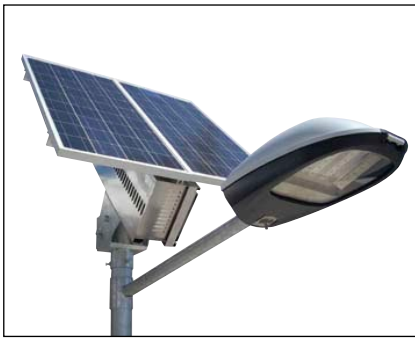
Bild 7: Phaesun PV-LED Street Lamp, 36 W, 12 h tgl. Leuchtdauer, drei Tage Speicherkapazität; Stärken S-M-L.
