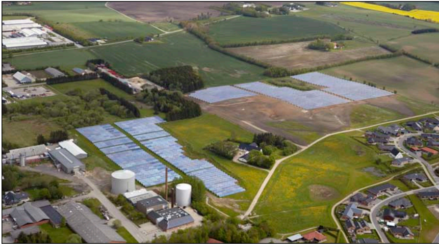
Bild 1: Sonnenfelder wie diese im Ort Braedstrup sind in Dänemark ein häufiger Anblick. Auch diese Kollektoren liefern Energie für das örtliche Fernwärmenetz.
