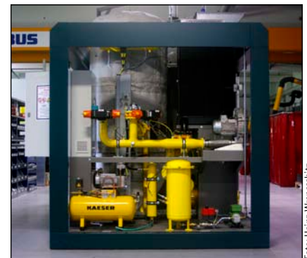
Bild 2: Holzvergaser-Blockheizkraftwerke von Burkhardt aus Mühlhausen in der Oberpfalz: Aufbau der Holzvergaseranlage in einer Art Containerbauweise
