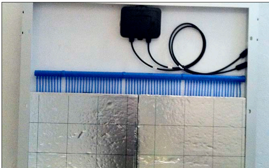
Bild 3: Wärme-isolierte Kapillarrohrmatte an der Rückseite eines Moduls. Hier schränkt die Anschlussdose mit den „Kabelzöpfen“ die für den Wärmeübergang nutzbare Fläche ein.
