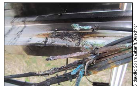
Bild 2: Durch Steckerbrand zerstörte benachbarte DC-Leitungen
