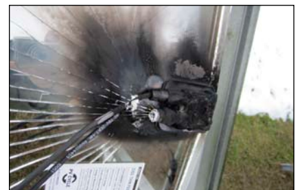
Bild 2: Durch Steckerbrand zerstörte benachbarte DC-Leitungen
