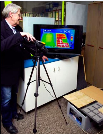
Bild 1: Erfinder Dipl.-Ing. Udo Betzel führt mit einer Wärmebildkamera vor, wie schnell das EMCH-Cellheizsystem (unten) durch verschiedene Bodenbeläge hindurch heizt.
