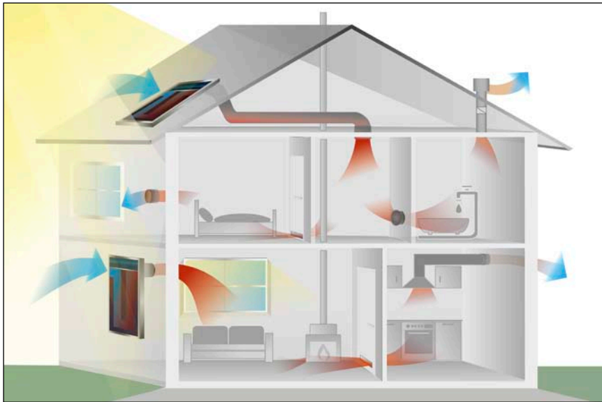
Bild 1: Solarluft-Anlagen können das ganze Haus mit frischer warmer Luft versorgen – ganz ohne intern verlegte Rohre.
