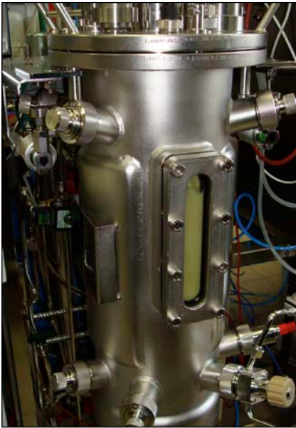
Bild 1: Der Methanisierungs-Reaktor im Technikum-Maßstab
