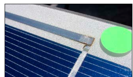
Bild 2: Heiße Lötverbindung in einem PV-Modul
