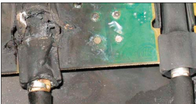
Bild 9: beschädigter Steckkontakt in einer Modulanschlussdose
