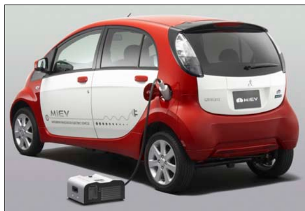
Bild 3: Seit 2012 wird in Japan die PowerBox verkauft. Mit dem kleinen grauen Kasten kann man die Energie aus dem Fahrzeugakku zur Versorgung von kleinen Stromverbrauchern (max. 1.500 Watt) mit 110 Volt Netzspannung nutzen. Ein ähnliches Produkt für 230 Volt gibt es bisher nicht.
