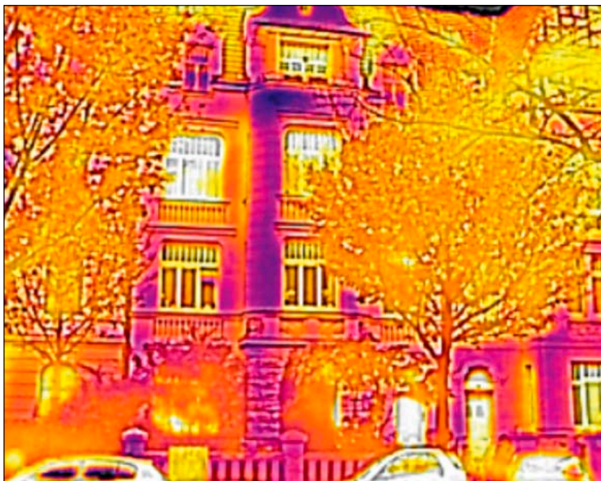
Bild 1: Vorstehende Hausecken kühlen schnell aus
