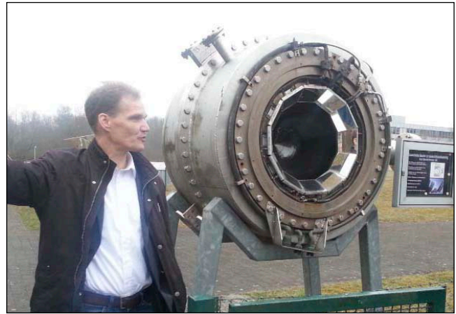
Bild 2: Volumetrischer Receiver zur solaren Methanreformierung (Wasserstoffherzeugung) (SCR)
