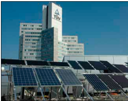
Bild 1: Outdoor-Teststand für Solarmodule beim TÜV Rheinland in Köln.
