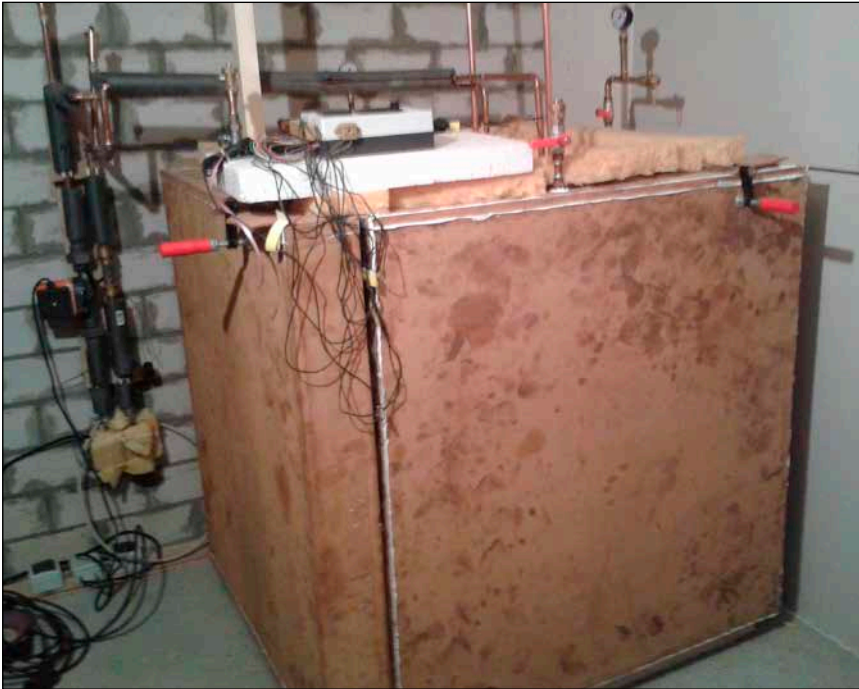
Bild 1: Versuchsaufbau eines Feststoffspeichermoduls mit Bodenmaterialien als Speichermedium (mit einer in der Entwicklung befindlichen regenerierbaren Vakuumisolierung)
