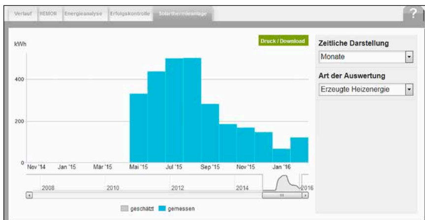
Bild 2: Bilanz des Solar-Wärmemengenzählers bei einem 10 m 2 Kollektor (Standort Oberbayern, Südabweichung 46° West, Neigung 26°)
