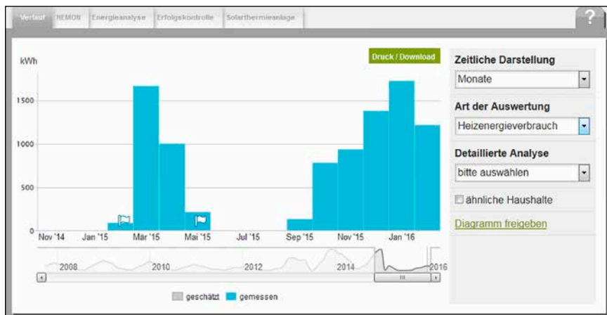
Bild 1: Verlauf des Nachheizbedarfs nach Installation einer Nahwärmehheizung (Ende Februar) und eines Sonnenkollektors (Anfang Mai)
