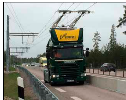
Bild 3, 4: BYD (links) produziert seit einigen Monaten auch Elektro-LKWs; vom Kleintransporter bis zum Sattelschlepper. Diese Fahrzeuge besitzen meist 150 km Reichweite und sogar die Fähigkeit eigene (Not)Stromnetze aufzubauen („V2G-Technik“). Im Juni 2016 wurde in Schweden die erste Teststrecke des E-Highway in Betrieb genommen (rechts). Auf rund 2 km Länge testen Scania und Siemens den Betrieb von E-Hybrid-LKWs mit Oberleitung um so bald auch die Langstrecken elektrisch zu fahren.
