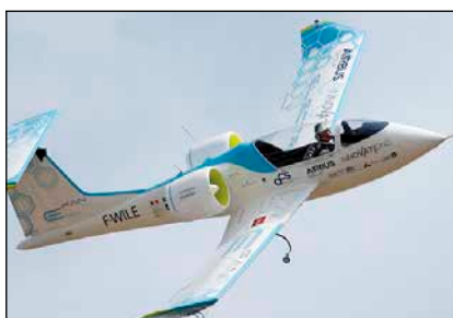
Bild 7, 8: Aktuelle Beispiele aus dem Bereich der elektrischen Luftfahrt. Der Airbus E-Fan (links) hat einen 29 kWh Akku und kann etwa eine Stunde in der Luft bleiben. 2017 soll der E-Fan 2 als zweisitzige Version fliegen. Rechts sieht man die Fotomontage der rein elektrischen NASA X-57 „Maxwell“. Derzeit wird noch der Flügel erprobt. Er hat zwölf kleine E-Motoren an der Vorderkante. Die NASA hofft auf eine Effizienzsteigerung um den Faktor 4 bis 5 gegenüber der heutigen Turboprop-Version.
