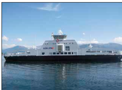
Bild 5, 6: Elektrische Schifffahrt zählt zu den ambitioniertesten Zielen. Links sieht man die ZeroCat der norwegischen Fjellstrand Werft. Die rein elektrische Fähre ist seit 2015 in Betrieb und befördert bis zu 120 Autos und 360 Fahrgästen. Im Mai 2016 nahm die „Berlin“ ihre Arbeit auf der Route Rostock-Gedser auf (rechts). Sie hat einen Hybridantrieb und erzeugt den Strom an Bord mit Hilfe eigener Generatoren. 15% Treibstoffeinsparung erhofft sich die Reederei von der neuen Technik.
