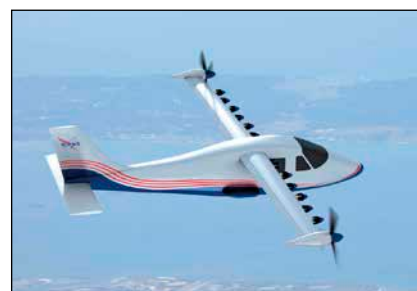
Bild 7, 8: Aktuelle Beispiele aus dem Bereich der elektrischen Luftfahrt. Der Airbus E-Fan (links) hat einen 29 kWh Akku und kann etwa eine Stunde in der Luft bleiben. 2017 soll der E-Fan 2 als zweisitzige Version fliegen. Rechts sieht man die Fotomontage der rein elektrischen NASA X-57 „Maxwell“. Derzeit wird noch der Flügel erprobt. Er hat zwölf kleine E-Motoren an der Vorderkante. Die NASA hofft auf eine Effizienzsteigerung um den Faktor 4 bis 5 gegenüber der heutigen Turboprop-Version.
