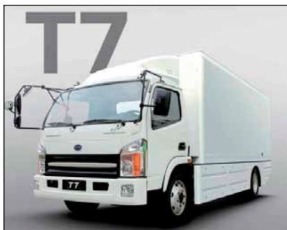
Bild 3, 4: BYD (links) produziert seit einigen Monaten auch Elektro-LKWs; vom Kleintransporter bis zum Sattelschlepper. Diese Fahrzeuge besitzen meist 150 km Reichweite und sogar die Fähigkeit eigene (Not)Stromnetze aufzubauen („V2G-Technik“). Im Juni 2016 wurde in Schweden die erste Teststrecke des E-Highway in Betrieb genommen (rechts). Auf rund 2 km Länge testen Scania und Siemens den Betrieb von E-Hybrid-LKWs mit Oberleitung um so bald auch die Langstrecken elektrisch zu fahren.
