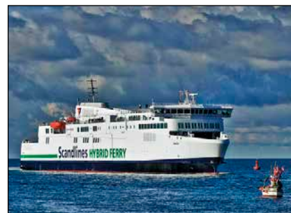
Bild 5, 6: Elektrische Schifffahrt zählt zu den ambitioniertesten Zielen. Links sieht man die ZeroCat der norwegischen Fjellstrand Werft. Die rein elektrische Fähre ist seit 2015 in Betrieb und befördert bis zu 120 Autos und 360 Fahrgästen. Im Mai 2016 nahm die „Berlin“ ihre Arbeit auf der Route Rostock-Gedser auf (rechts). Sie hat einen Hybridantrieb und erzeugt den Strom an Bord mit Hilfe eigener Generatoren. 15% Treibstoffeinsparung erhofft sich die Reederei von der neuen Technik.
