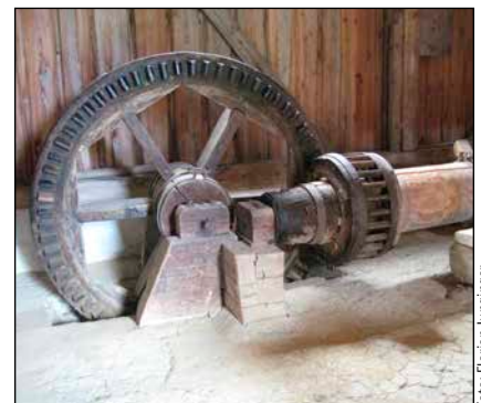
Bild 3: Getriebe zum Antrieb eines Hammerwerks
