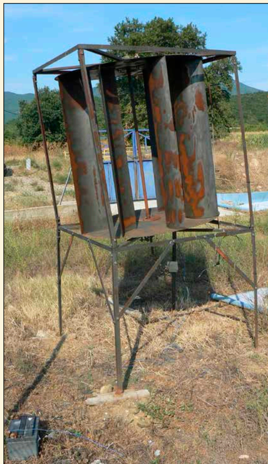
Mit ihrer vertikalen Achse fungiert die einfache Windturbine unabhängig von der Windrichtung
