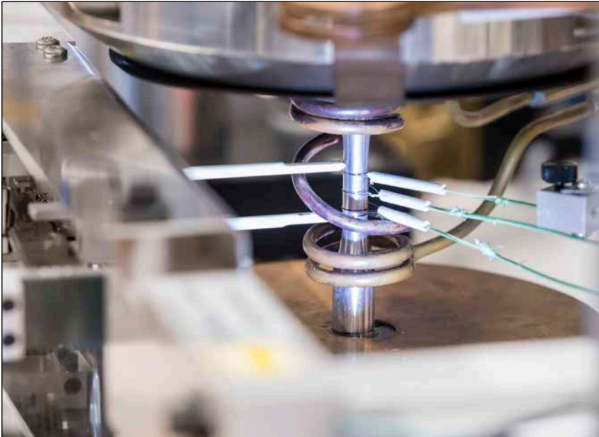
Bild 1: Alterung von Freileitungen: Am Teststand der EMPA werden Leiterseile belastet
