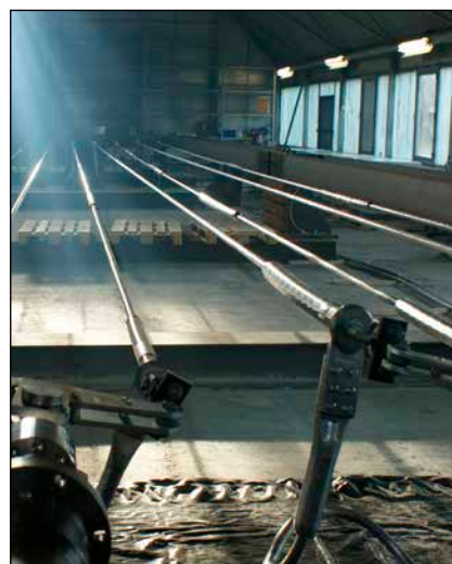
Bild 2: Versuchsstand mit HTLS-Leitenseilen
