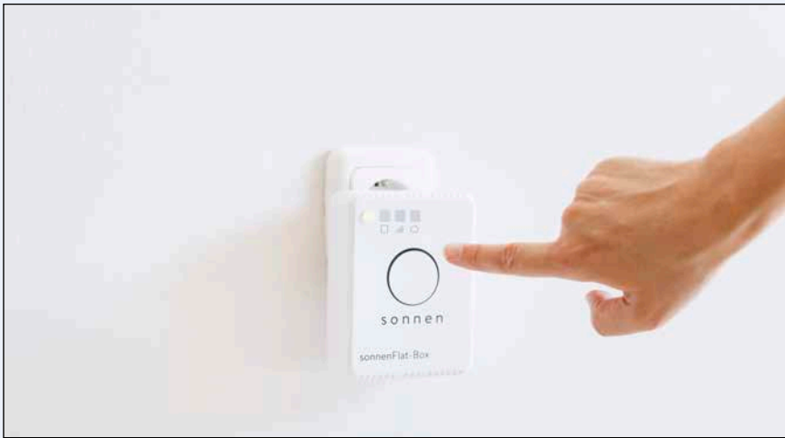
Bild 1: Die sonnen Flat-Box wird in eine freie Steckdose im Haus des Kunden eingesteckt. In ihr steckt eine Technologie, mit der die einzelnen sonnen Batterien zu einem Pool verbunden werden und so am Regelleistungsmarkt teilnehmen können
