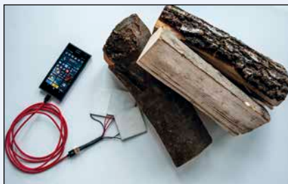
Bild 3: Strom aus Holz / Thermoelektrische Module
