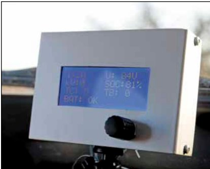
Bild 3: Dank einer Anzeige hat man stets alles im Blick, etwa den Entnahmestrom bzw. die Rekuperation beim Bremsen
