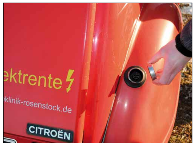
Bild 7: Der Anschluss für das Ladekabel fand Platz im ehemaligen Füllstutzen
