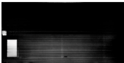
Bild 7: EL-Aufnahme eines rückbestromten, pid-geschädigten CIGS-Solarmoduls (Rest-Nennleistung ca. 34 Wp statt ca. 70 Wp)
