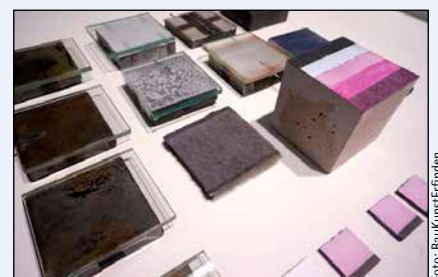
Bild 2: DysCrete Funktionsmodell Schichtaufbau
