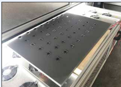
Bild 3: DysCrete Modul im Sonnensimulator
