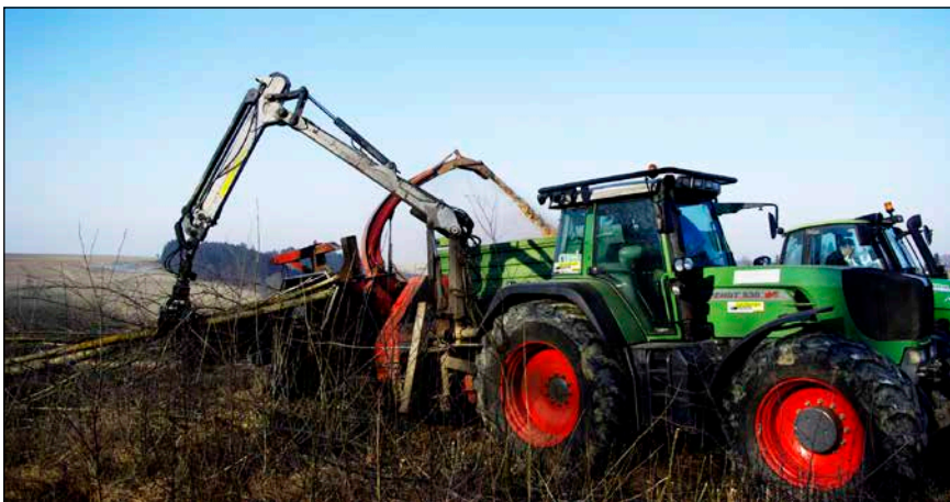
Bild 3: Herstellen von Holz hackschnitzeln
