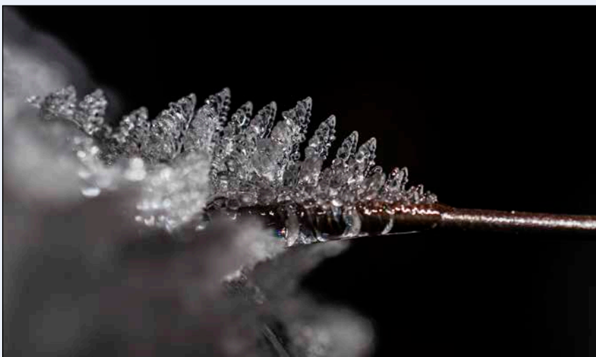
Bild 4: Salzkristalle: Speichermedium mit vielen Möglichkeiten: Salz ist kostengünstig und kann in flüssiger Form bei Temperaturen zwischen 170 und 560 Grad Celsius eingesetzt werden
