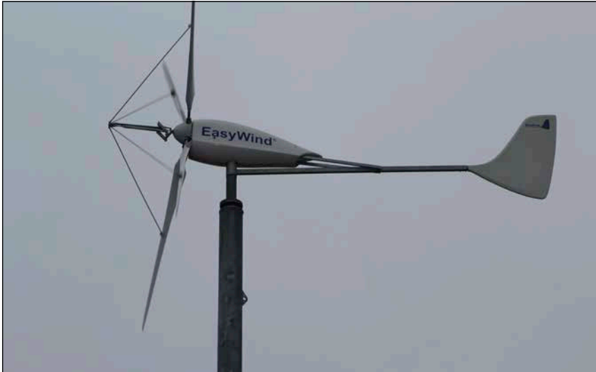
Bild 1: Die 6-kW-Kleinwindanlage von Easywind steht auf einem 19 m hohen Stahlurm (Gesamthöhe 22,40 m).
