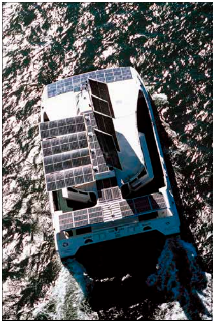
Solarpanels, die sich auch als Segel nutzen lassen: Flächensynergie bei der „SSS“ von OCIUS/Australien
