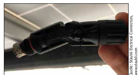
Bild 5: Verformte Steckverbinder-Verbindung (Kreuzverbund)
