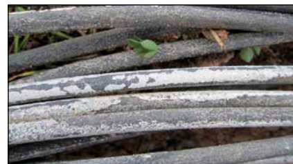
Bild 7: Im Erdreich verlegte, mangelhafte Stringleitungen
