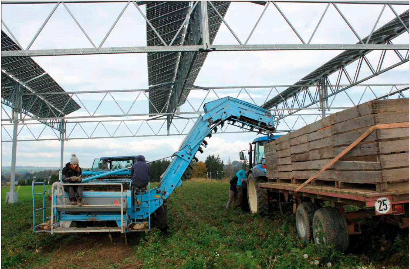
Bild 1: SELLERIE EN PASSANT: Knollen aus der Erde holen und obendrein Sonnenstrom einfangen ist die Idee der Agrophotovoltaik.
