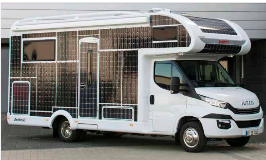
Bild 8: Dethleffs 2017 als Prototyp vorgestelltes, vollelektrisches Solarwohnmobil
