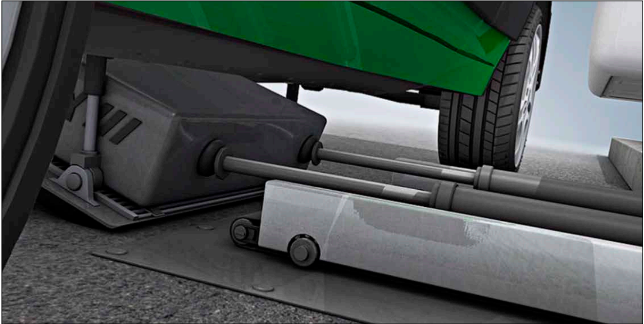
Bild 1: Akkutausch von der Seite mit dem schwedischen Powerswap-System
