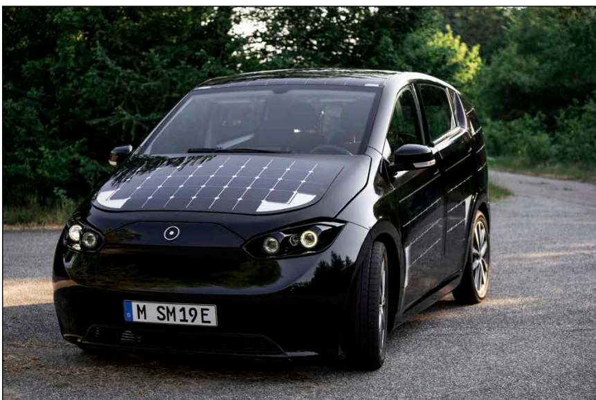
Bild 7: Prototyp des Sion mit großen PV-Flächen auf Motorhaube, Dach und an den Seiten
