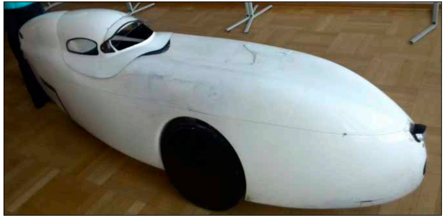
Bild 3: Nicht ein neuer chinesischer Elektroflitzer, sondern ein verkleidetes Fahrrad Marke Eigenbau, mit einem fitten Fahrer bis zu 50 km/h schnell.
