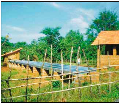
Bild 1: Tunneltrockner zum Trocknen von Lebensmitteln mit Solarenergie (German-Indian Solar Drying Project), entwickelt an der Technischen Universität München
