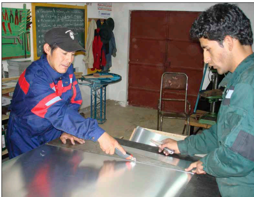
Bild 2: Zuschneiden von Hochglanz-Aluminium-Blechen in einer Werkstatt in Bolivien für die Herstellung von Solarkochern der SK-Bauweise. Projekt SOLIN von J. A. Garrido Vázquez, Madrid
