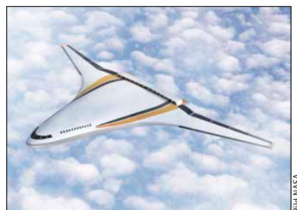
Bild 3: Die N3-X ist fast ein Nurflügler; sie hat ihre Fans hinten auf dem platten Rumpf.
