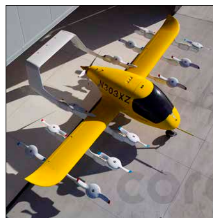
Bild 2: Mit einem Propeller, Flügeln und 12 Rotoren kann die Cora senk- und waagrecht starten.
