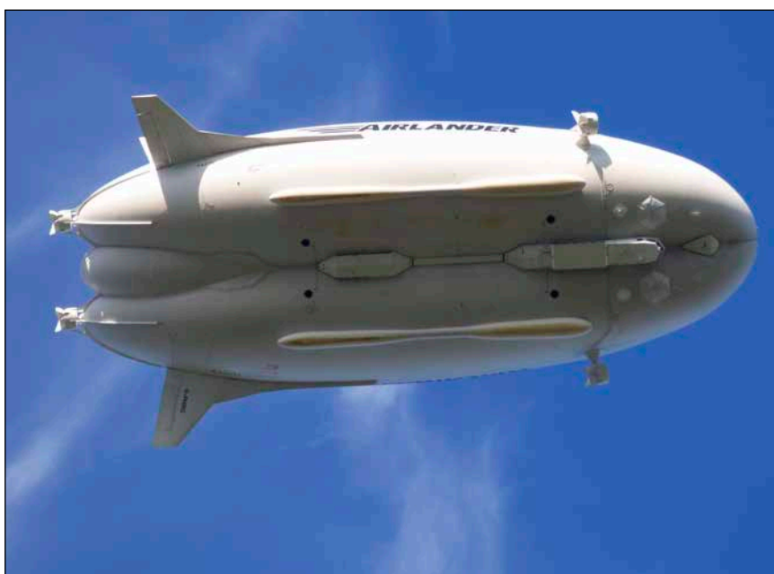
Bild 4: Das Hybridluftschiff Airlander von unten – deutlich sind die eher breite als runde Form und die Flügel für zusätzlichen Auftrieb.
