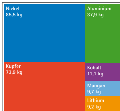
Bild 5: Zusammensetzung einer Li-Ionen-Batterie 9) eines e-Autos (100 kWh). Die Roh-Elemente (227 kg) müssen aus Handlings- und Sicherheitsgründen in eine Gehäusestruktur (ca. 500 kg) eingebaut werden. Das Gesamtgewicht von somit etwa 730 kg ist im Vergleich zu einem 50 Liter-Tank recht viel „Un-Nutzgewicht“. Ein VW Golf wiegt etwa 1.400 kg.
