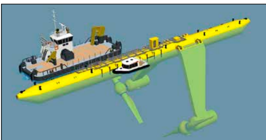
Bild 3: Die schwimmende Gezeitenturbine Orbital 02 mit einer Leistung von 2 MW
