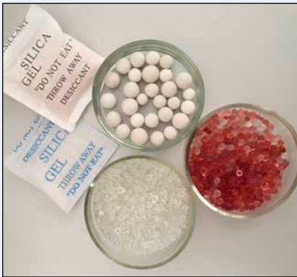
Bild 1: Kleine Stars: Silikagel-Kügelchen zum Heizen und Kühlen
