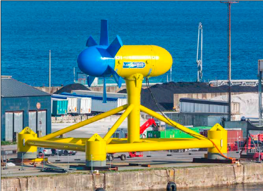
Bild 2: Auf dem Meeresgrund stehend: die Strömungsturbine Sabella D10. Anders als bei Windkraftanlagen sind Rotorachse und Rotorblätter in ihrer Ausrichtung nicht drehbar
