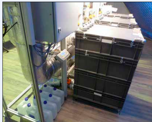
Bild 4: Mobile TAO-Speichermodule des Silikagel-Speichers
