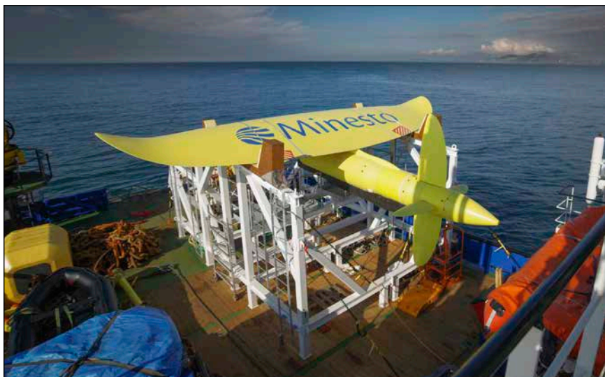
Bild 1: Auch wenn der Propeller hier durch den Flügel verdeckt ist: das Unterwasserflugzeug Deep Green von Minesto erntet die Energie der Meeresströmung, indem es waagerechte Achsen „fliegt“
