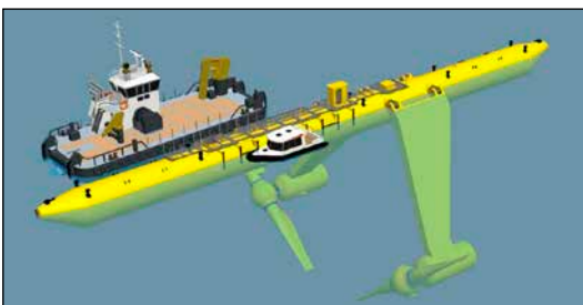
Bild 3: Die schwimmende Gezeitenturbine Orbital O2 mit einer Leistung von 2 MW
