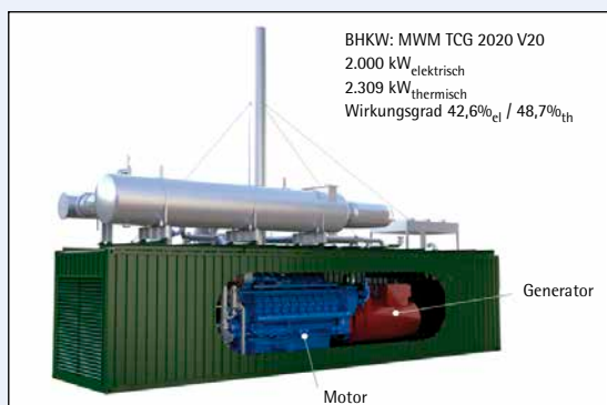
Bild 4: Voll flexibles 2 MW Blockheizkraftwerk
