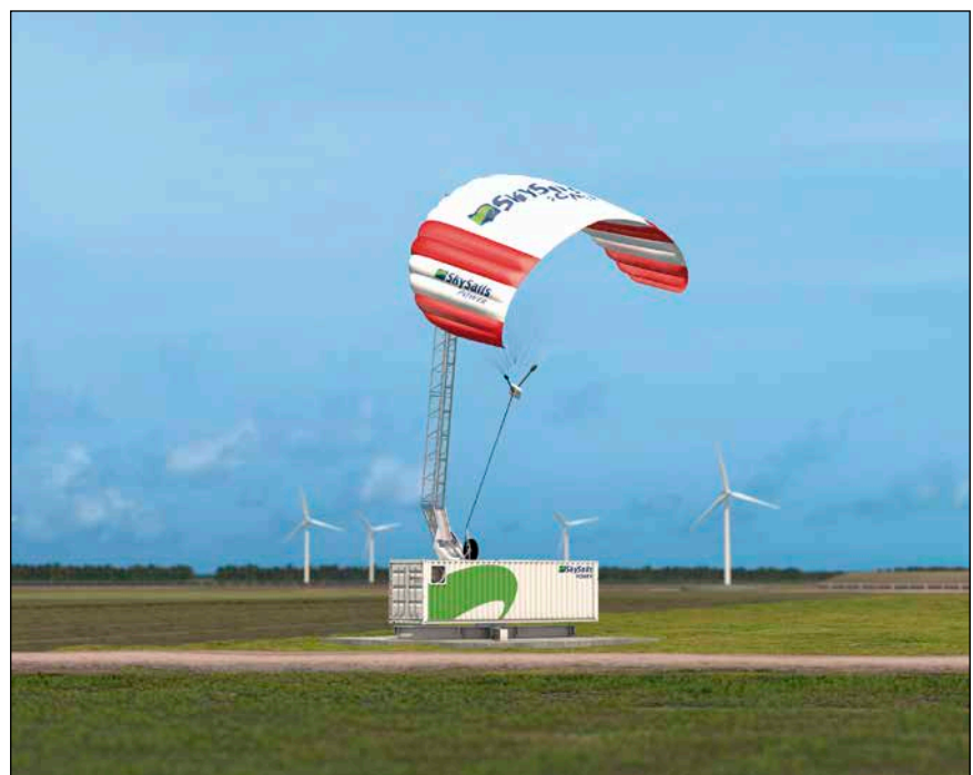
Bild 2: Flugdrachen mit Generator-Container und Startarm
