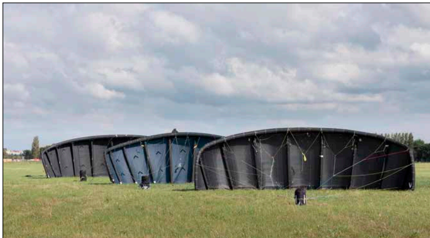
Bild 6: Flugwindkraftwerke von unten gesehen: die Rippen dienen zur Stabilisierung des Kites
