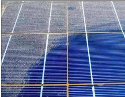
Bild 1: Deutlich sichtbarer Unterschied zwischen sauberer und verschmutzter Oberfläche. Die vorübergehende Leistungseinbuße in Höhe von 3% beseitigt aber der nächste Regen.
