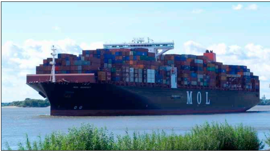
Bild 4: Die MOL Quintet auf der Elbe: ca. 370 m lang, 23 kn schnell, für rund 14.000 Container. Nicht nur für den Fluss ist ein solcher Container-Riese ungeeignet, sondern auch für Windantrieb.
