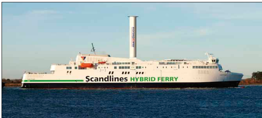
Bild 2: Im Mai wurde die Ostseefähre Copenhagen in Rostock mit einem Rotorsegel (Flettner-Rotor) der Fa. Norsepower ausgerüstet.
