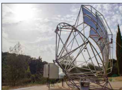
Bild 4: Leichtbaumembranspiegel mit ortsfestem Brennpunkt sorgt für die nötige Prozesswärme
