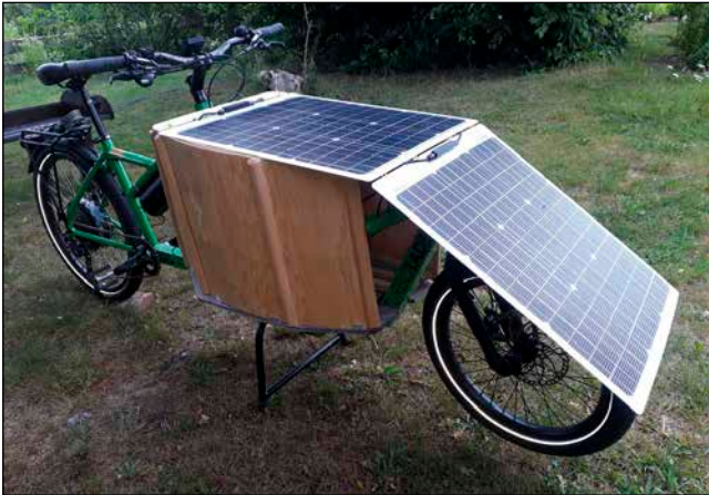
Lastenrad mit solar bestückter Transportkiste
