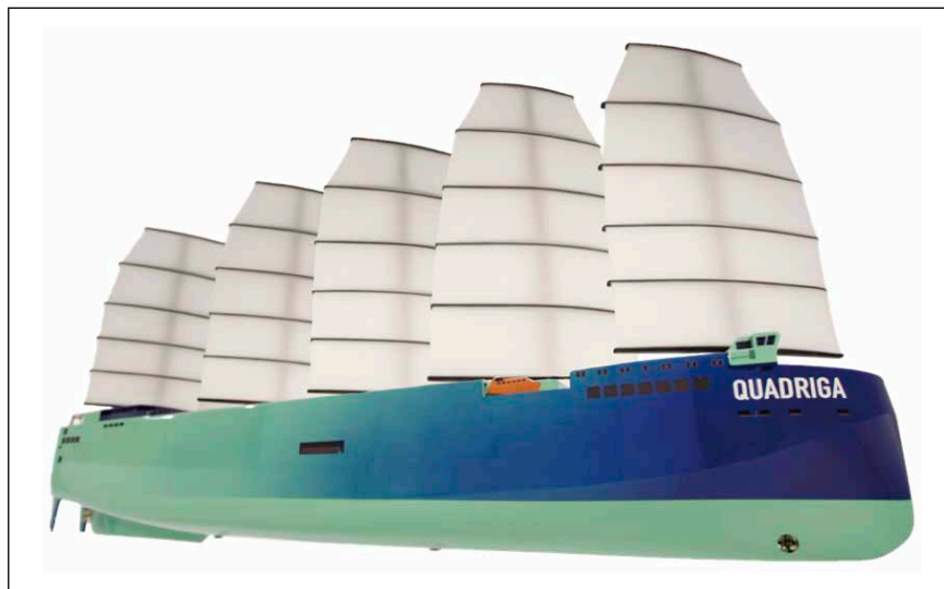
Bild 1: Entwurf eines modernen Rahseglers, der größtmäßig den heutigen Fossil-Frachtern in nichts nachsteht. Eine Version, die 240 Meter lange Quadriga Aqua, soll sogar als schwimmende Fisch-Farm dienen.
