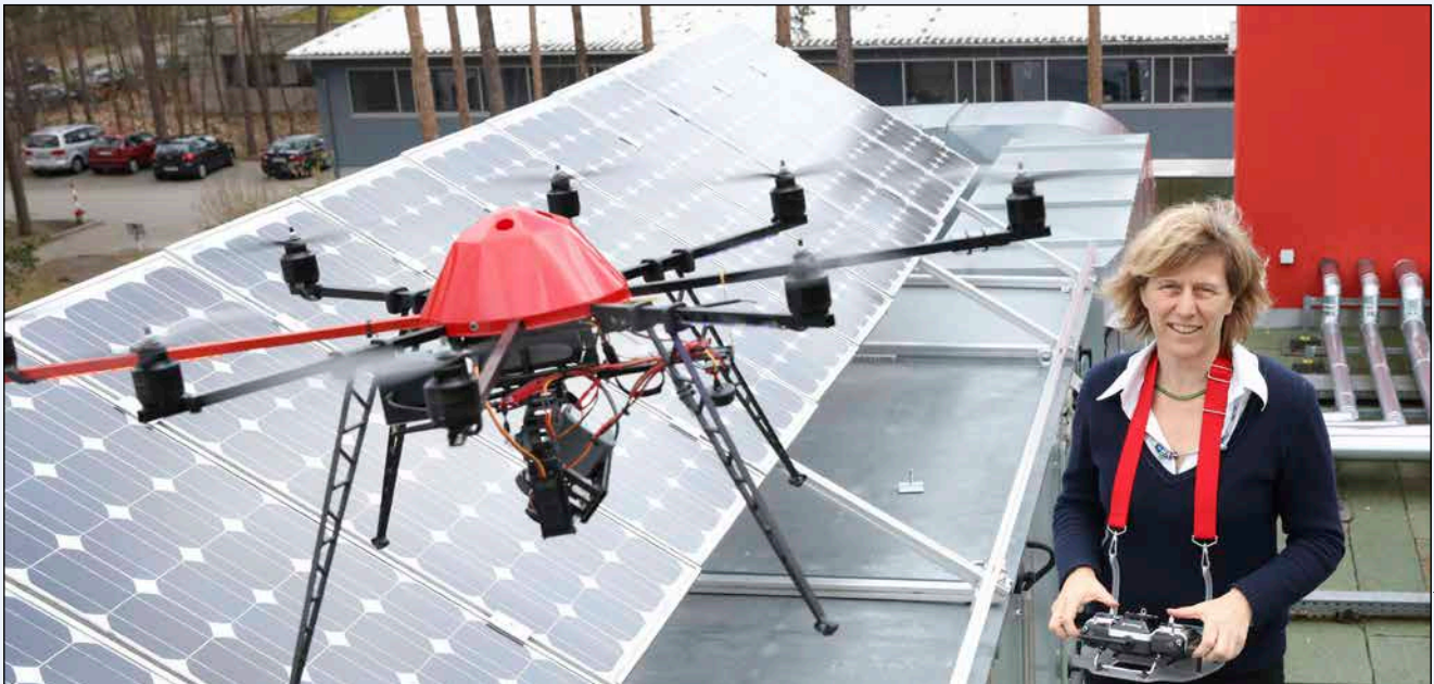
Bild 1: Dr. Claudia Buerhop-Lutz, Projektleiterin am Helmholtz-Institut Erlangen-Nürnberg mit einer Drohne zur Inspektion von PV-Anlagen. Ziel des von ihr geleiteten Projektes COSIMA ist es die Aufnahme von Bildern mit Drohnen und deren Auswertung vollständig zu automatisieren.
