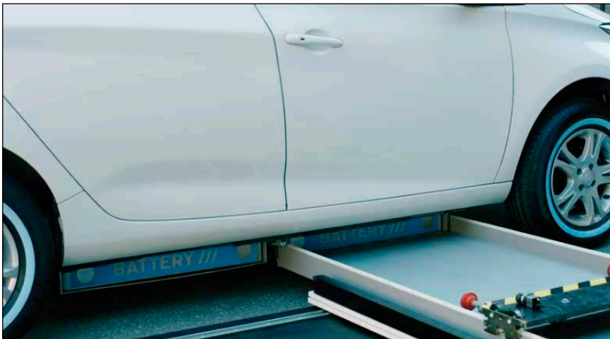
Bild 1: Das schwedische Powerswap-System als Vorbild: mittels spezieller Hubwagen könnten auch Privatleute die Akkus wechseln.
