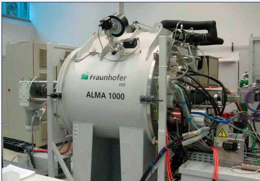
Bild 1: Drehtrommel-Anlage ALMA 1000 zur Metallisierung von Schüttgütern im Vakuum
