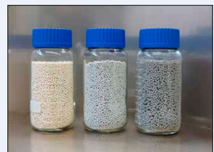
Bild 2: Zeolith-Granulat im Originalzustand (links) sowie mit Aluminium beschichtet (Mitte und rechts)
