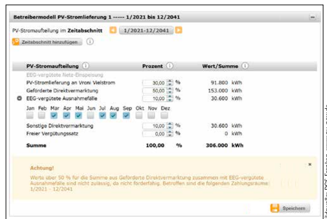
Bild 2: Kleine Wissenschaft für sich: (un)mögliche PV-Stromaufteilung einer 340 kWp PV-Anlage, Screenshot aus pv@now manager
