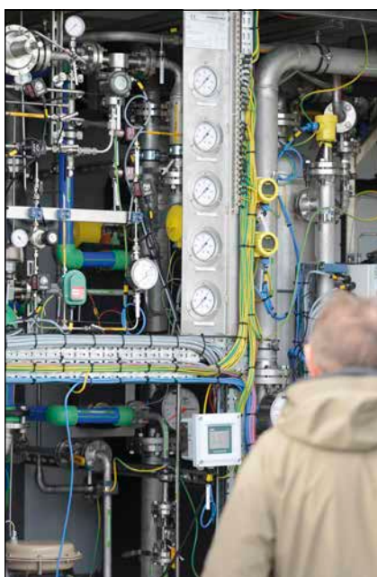
Bild 3: Blick in das Innere eines Elektrolyseurs
